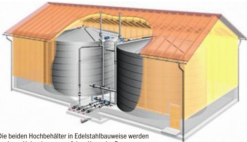
Die beiden Hochbehälter in Edelstahlbauweise werden in einem Holzschuppen auf dem Kappeler Berg unscheinbar in die Umgebung eingepasst. BILD: GERD JERGER
